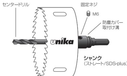
※ボール盤および振動ドリル(振動モード)、ハンマードリル
