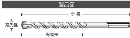
**特長** ▶ 鉄筋に当たっても噛み込みが少なく、刃先と外径の摩擦が少ないクロス刃により、安定した穿孔能力を維持。
